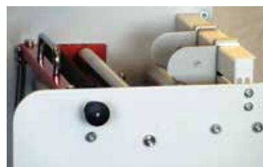
Cuchillas de corte con un sistema extremadamente simple para obtener el material impreso dividido.
